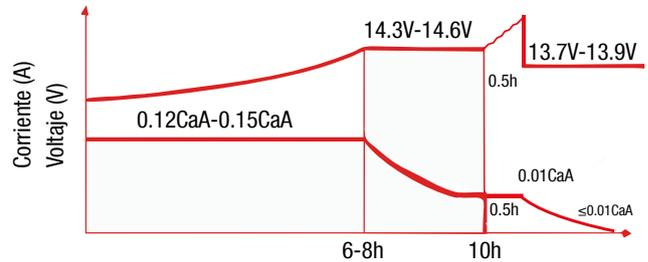
Paso 1: Carga de corriente constante con 0.12-0.15Ca hasta que el voltaje alcance 14.3-14.6V
