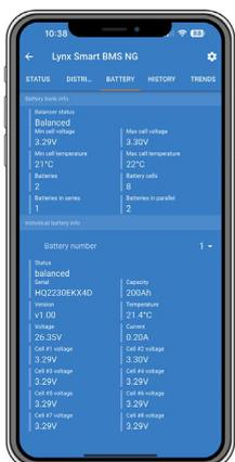
**Resumen completo de todos los datos de baterías mediante VictronConnect (o un dispositivo GX y VRM)**
